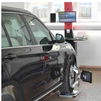
3D technológiával végzik a futómű beállítását
